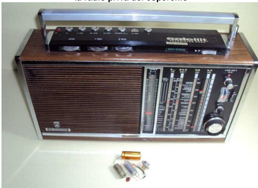
La radio dopo la riparazione con i componenti sostituiti
