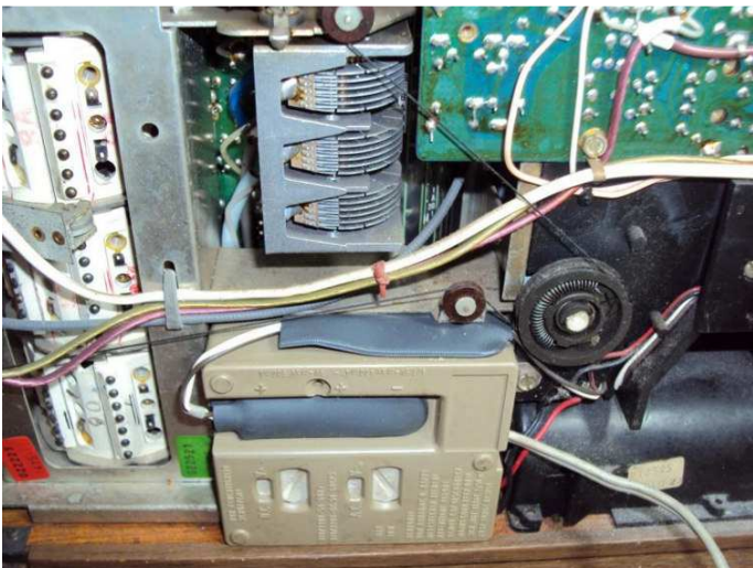
In evidenza l'alimentatore guasto
