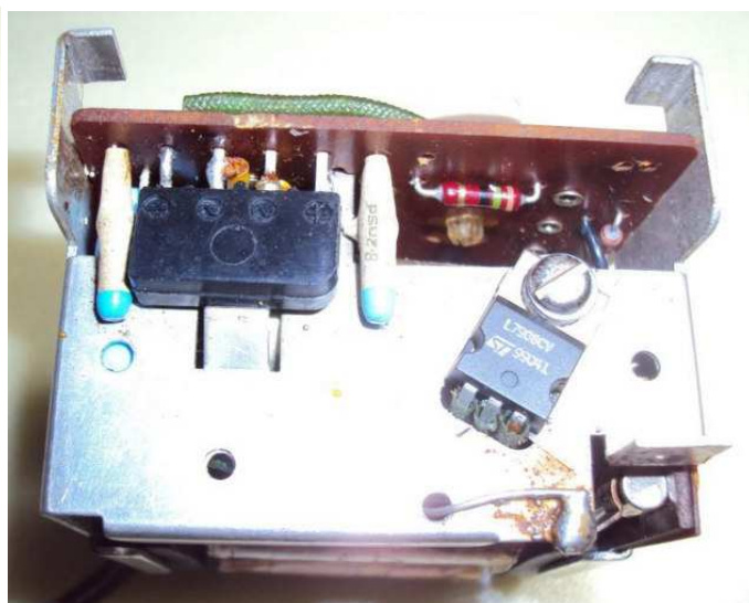
L'integrato L 7908 fissato sul telaio dissipatore
